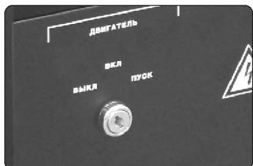
(c) Установите выключатель в положение «ВЫКЛ».
