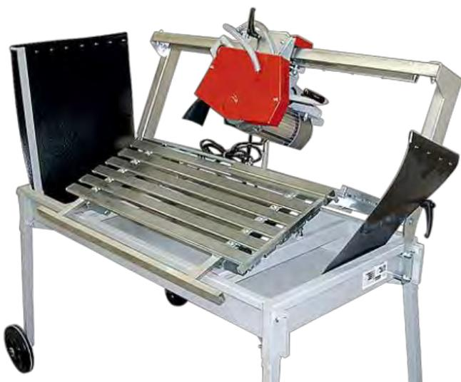
Камнерез с увеличенной длиной реза (1500 мм) с верхним расположением направляющей для резки плитки и камня. Позволяет производить резку под углом 45 град.
