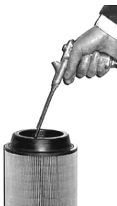
Рис. 10.3 Очистка фильтрующего элемента воздушного фильтра
