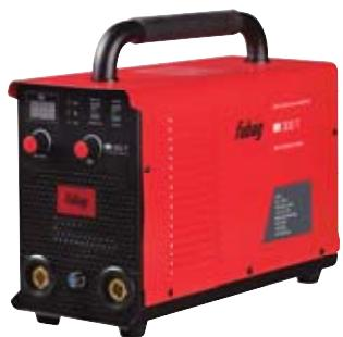
**Самый мощный в серии IR трёхфазный сварочный инвертор с максимальным током 300 А. Обеспечивает идеальную сварку электродами диаметром до 6 мм. В аппарате реализована ручная регулировка силы дуги. Может подключаться к пульту дистанционного управления.**
