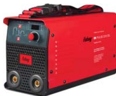
Универсальный сварочный инвертор для ручной дуговой и аргонодуговой сварки методом TIG Lift. Отлично справляется с работами в труднодоступных местах или на высоте. Стабильно работает в диапазоне напряжения 110–230 В. Как и все инверторы серии IN PULSE, работает в импульсном режиме сварки MMA. За счет профессиональной панели управления удобен и прост в настройках и контроле сварочного процесса.
