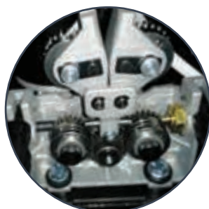
Подающий механизм Drive INMIG с 4-х роликовым приводом подачи проволоки
