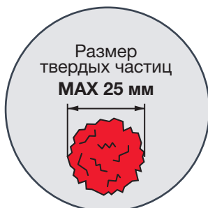
Возможность качать воду с частицами до 25 мм
